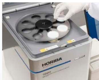
A bandeja giratória opcional de 8 posições permite maior flexibilidade.
